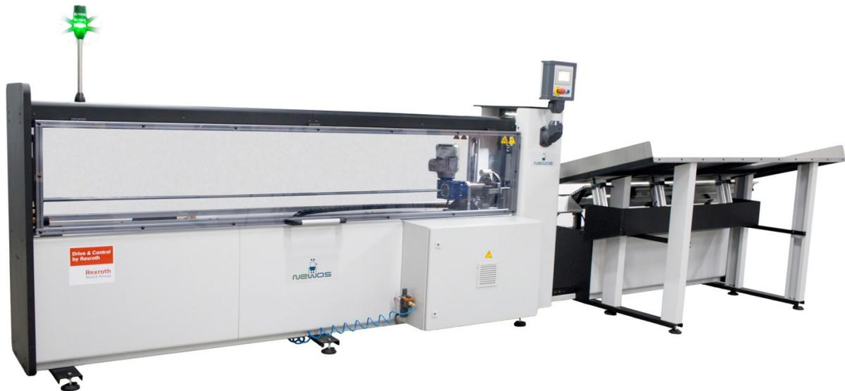
Unser automatischer Hülsenschneider nach dem neusten Stand der Technik beinhaltet einen 4-Achsen Servoantrieb. Mit geringem Investitionsaufwand werden dabei alle Bedürfnisse von kleinen und mittelständischen Unternehmen abgedeckt. Der vollautomatische Hülsenschneider ermöglicht Ihnen das Schneiden Ihrer Papphülsen, während der Maschinenbediener sich anderen Aufgaben widmen kann. Über das Bedienfeld werden Hülsenlänge, Hülsenmaß und die jeweilige Anzahl der zu schneidenden Hülsen eingegeben.
